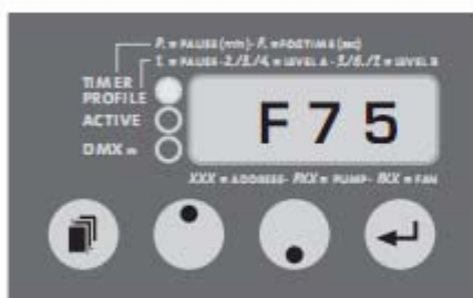
Fig. 12: Adjusting the fan
